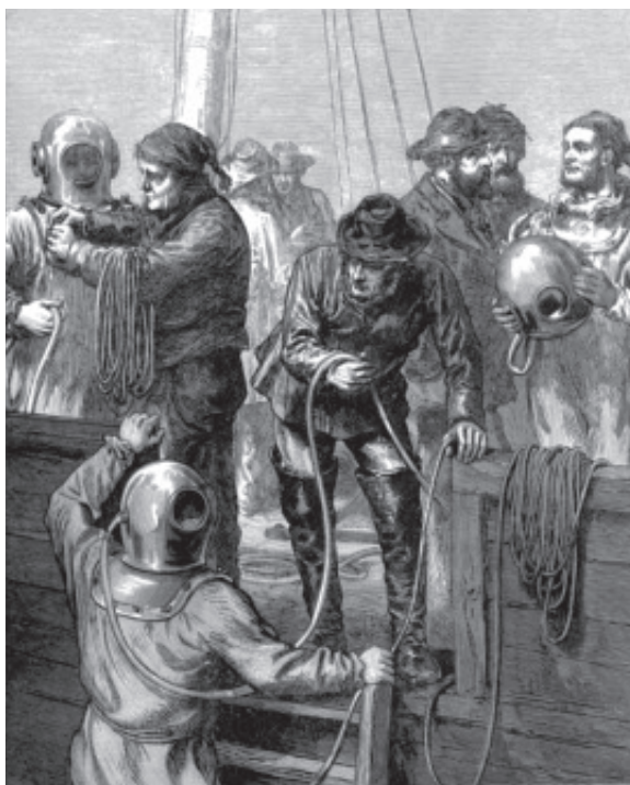
Figur 4. Augustus Siebes lukkede dykkerdragt, som den var modificeret i 1873. Dykkere forbereder arbejdet. Forsideillustration på 06 februar 1873-udgaven af The Illustrated London News. Selv om det ikke udtrykkeligt nævnes, omtales i et tidligere nummer, at dykkere blev sendt ned til vraket af den fuldriggede fregat Northfleet, som sank i den Engelske Kanal 22 januar, for blandt andet at fjerne lig fra vraket.
