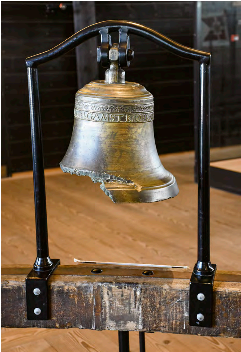
Figur 3. Fregatten Jyllands skibsklokke, som mangler et stort fragment efter at være ramt af en fjendtlig kugle ved slaget ved Helgoland. (Den selvejende institution Fregatten Jylland. Foto: Ole Sonne)
