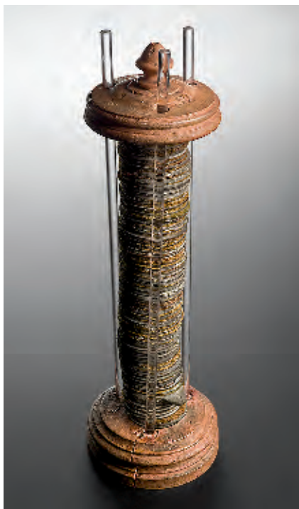
Figur 3. En voltasøjle. Under tiden anvendes udtrykket et “galvanisk element” synonymt med voltasøjle. Det var historiens første elektriske element. Det frembragte elektrisk strøm gennem kemiske processer. En voltasøjle bestod af en stabel af to forskellige metalplader med et stykke stof eller papir vædet i en elektrolyt indskudt imellem de to metaller [4 s. 16]. Volta anvendte zink- og kobberplader og svovlsyre som elektrolyt. Metallernes kontakt med elektrolytten får dem til at afgive ioner (elektriske ladninger). De elektriske ladninger kunne uddrives fra voltasøjlen gennem en elektrisk leder (f.eks. en kobbertråd). Det beskrev man i datidens sprog som en elektromotorisk kraft svarende til elektrisk spænding i vore dages sprog. Denne Voltasøjle var udstillet på Volta Centenary Exhibition i Voltas fødeby Como i Italien i 1899 og et af de få instrumenter, som overlevede en brand. Science Museum, London. Foto: The Wellcome Library, London (L0057740).
