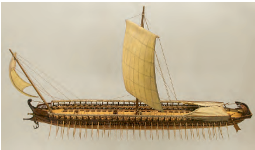
Figur 5. Model af en græsk trireme, hvor roerne sad i tre etager. Denne type fartøj var almindeligt udbredt i Middelhavet blandt fönikere, grækere og romere. Deutsches Museum, München, Tyskland, Wikimedia Commons.
