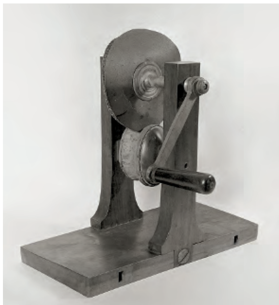
Figur 2. Elektrisermaskine, et apparat som i 1700-tallet brugtes til at frembringe gnidningselektricitet. Det kunne foregå ved, at en drejelig glasskive blev drejet og dermed gnedet mod et stykke stof eller læder. En elektrisermaskine kunne have en stoftråd eller kobbertråd, der ved berøring afgav både gnister og elektriske stød til omgivelserne. The Wellcome Library, London (L0011370).
