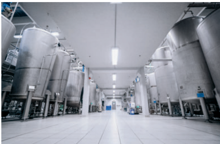
Figur 3. Her ses de store fermenteringstanke, hvor bakterierne opdyrkes til produktion af forskellige antibiotika som Dumocyclin og polymyxiner, det vil sige colistimethatnatrium og polymyxin B hos Xellia Pharmaceuticals. (Tak til Xellia for brug af foto)
